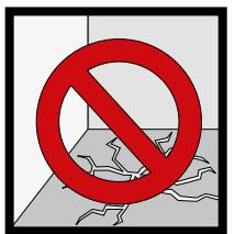
**Рис. 27.** Перед началом укладки необходимо заделать имеющиеся трещины.
