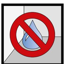
**Рис. 23.** Проверка может выполняться с помощью гигрометра для строительных материалов. Ориентировочно подходящими считаются значения влажности до 2 % перед укладкой.
