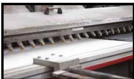
**Рис. 21.** Для резки под углом 45° можно использовать алмазные диски со скосом под углом 45°, что позволяет выполнить кромку сразу на двух плитах KERLITE любого типа. После этого необходимо сладить угол новой кромки. С помощью разных дисков можно получить различные варианты отделки кромки. Скорость обработки нужно проверить заранее.
