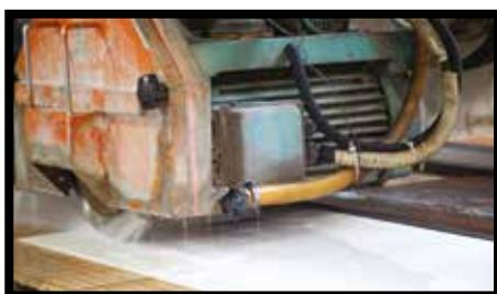
**Рис. 15.** Все разновидности плит KERLITE можно резать алмазными дисками. Следует выбрать специальные диски, предназначенные для резки керамогранита и находящиеся в хорошем состоянии. Рекомендуется работать на высокой скорости вращения (>2000 об./мин.) и поступательной скорости от 0,5 до 1 м/мин. В зависимости от типа диска и длины реза может потребоваться водяное охлаждение диска. В то же время, на входе и выходе инструмента из плиты рекомендуется снижать скорость вращения.
