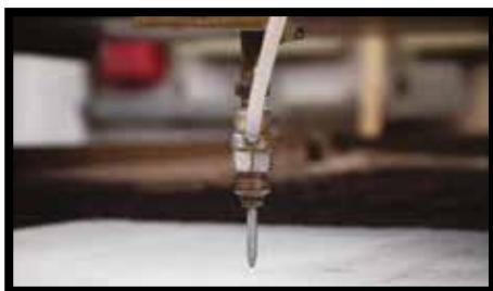
**Рис. 19.** Все разновидности плит KERLITE можно сверлить на гидроабразивных станках.
