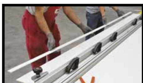
**Рис. 5.** Удобным для резки инструментом является специальная линейка для резки плитки (типа Keracut марки **Sigma** или Free-cut марки **Raimondi**). При работе с KERLITE 3PLUS и KERLITE 5PLUS даже при использовании указанного приспособления после надреза и разделения керамической части нужно разрезать стекловолокно обычным ножом-резаком (**рис. 4**).
