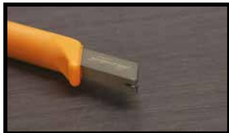
**Рис. 1.** Прямые и фигурные резы на различных типах плит KERLITE можно выполнять с помощью стеклорезов, например, специализированного стеклореза Silberschnitt 2000 марки **Bohle Italia** или ручных плиткорезов марки **Würth**. Для качественной резки очень важно не смещать инструмент с оси реза в ходе всей операции.
