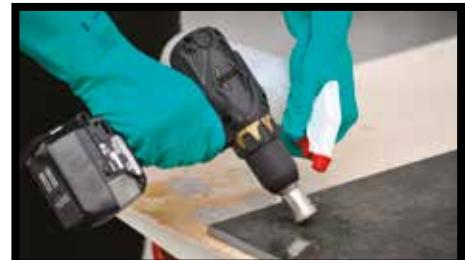
**Рис. 9-10.** Как альтернативный вариант можно использовать корончатые фрезы или пустотельные сверла, установленные на шлифовальную машину, электрическую дрель или шуруповерт на аккумуляторах.
