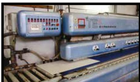
**Рис. 20.** Для формирования и полировки кромки следует в первую очередь придать кромке необходимый размер и форму посредством алмазных и абразивных кругов, после чего использовать шлифовальный круг. С помощью разных кругов можно получить различные варианты отделки. Скорость обработки нужно проверить заранее.
