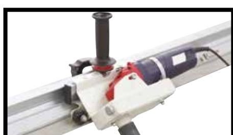
**Рис. 6.** Наряду с линейкой для резки плитки можно использовать ручные угловые шлифовальные машины, установленные на специальную раму, которые вставляются в направляющую резки. За счет этого можно выполнять резку под углом 90° или 45° для получения скосов и специальных профилей.
