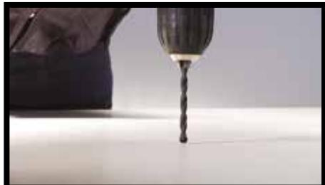
**Рис. 8.** Для сверления отверстий вручную используются вольфрамовые сверла диаметром до 10 мм, установленные на электрическую дрель или шуруповерт на аккумуляторах.
